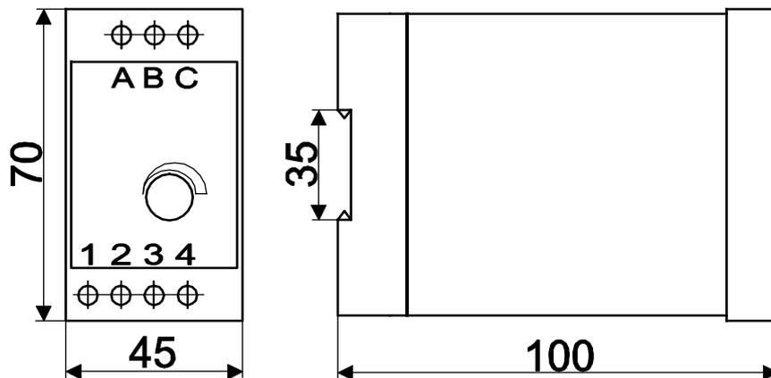
Рисунок 1 - Габаритные и установочные размеры реле
